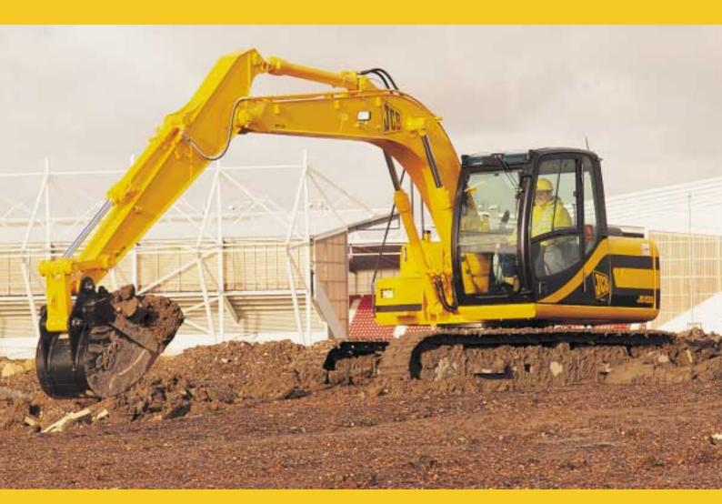
MAX. OPERATING WEIGHT: 13900 kg NETT ENGINE POWER: 63 kW (85 hp)
